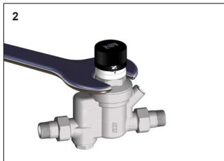
2- Utilizzando una chiave da 36mm, svitare la parte superiore del riduttore.
